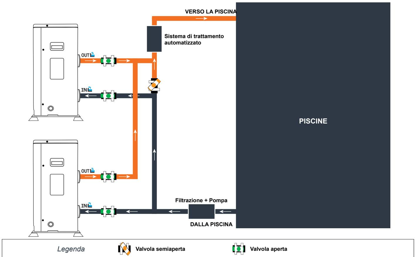
Il filtro a monte della pompa di calore deve essere pulito regolarmente affinché l'acqua del circuito sia pulita e, in tal modo, si evitino problemi di funzionamento dovuti alla sporcizia o all'intasamento del filtro.
