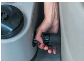
8) Conecta el bloque motor al spa, enrosca los tres conectores al spa.
