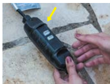
2. Drücken Sie die Reset-Taste, die Anzeige wird rot.
